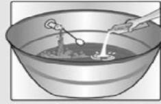
**4** Abra o registro de entrada da água no cavalete e deixe encher a caixa d'água. Acrescente 1 litro de água sanitária para cada 1000 litros de água.
